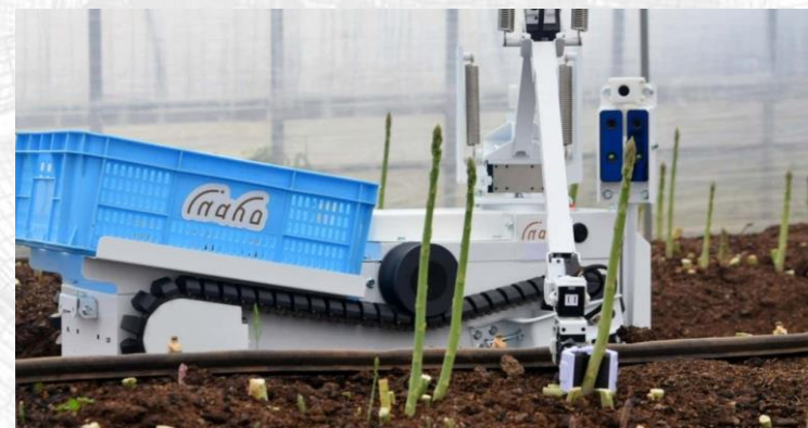
アスパラガスを収穫するロボットサービスモデル（RaaS）
